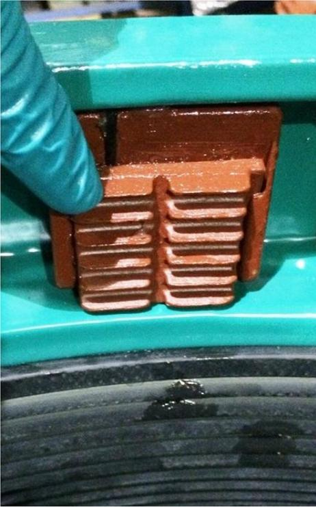
3. MAKE SURE THAT THE GRIPPERS ARE PUSHED ALL THE WAY TOWARDS THE GASKET AS SHOWN IN THIS PICTURE.
